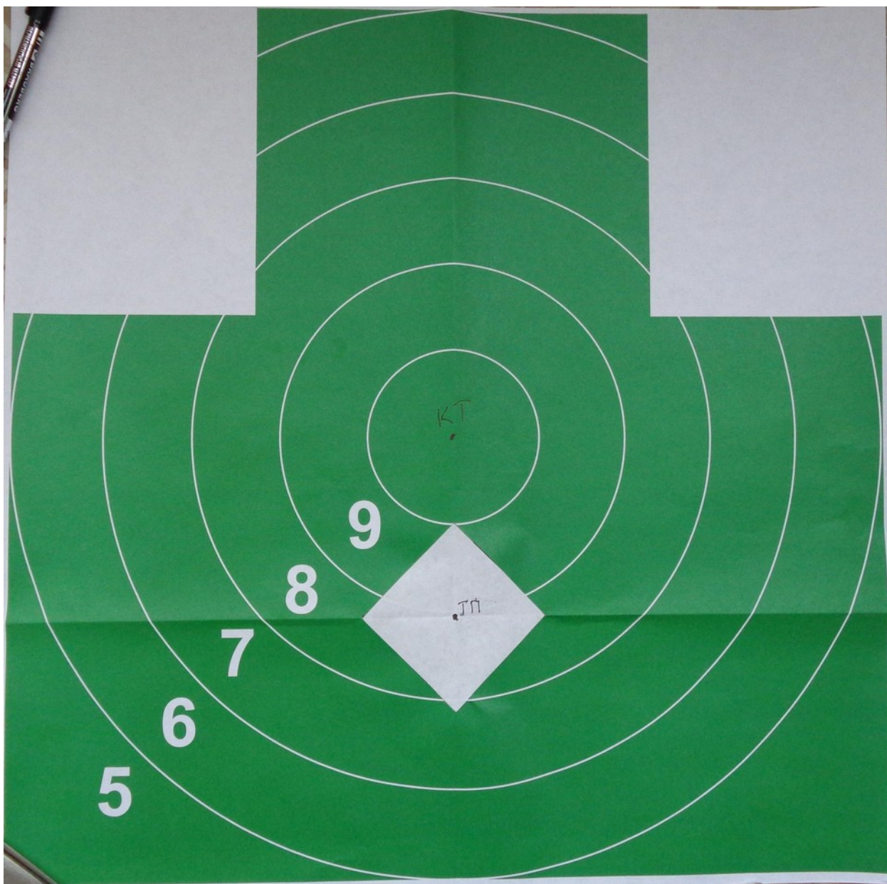
Фиг. Б.1.4.3 : Мишень №4 с квадратом для прицела П_0,15. Здесь превышение КТ над ТП равно 10,2 см для навесного прицела высотой 3 см на АК74, дальность 100 м — Таблица 3 на стр. 10
