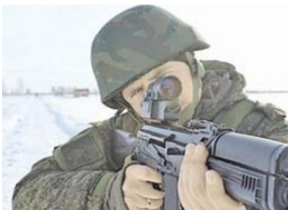
Фиг. Е.3.1.3 : Коллиматорный прицел 1П63 на АК74М
