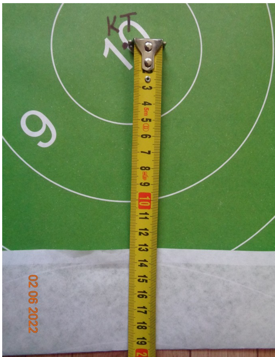
Фиг. Б.1.3.2 : Превышение 13 см из Таблица 1 для открытого прицела 3 на АК74, дальность 100 м
